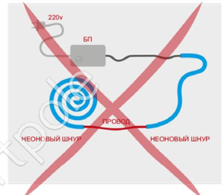
При необходимости расположить БП на расстоянии от шнура, можно удлинить провод между БП и неоновым шнуром на расстояние до 10 м.
